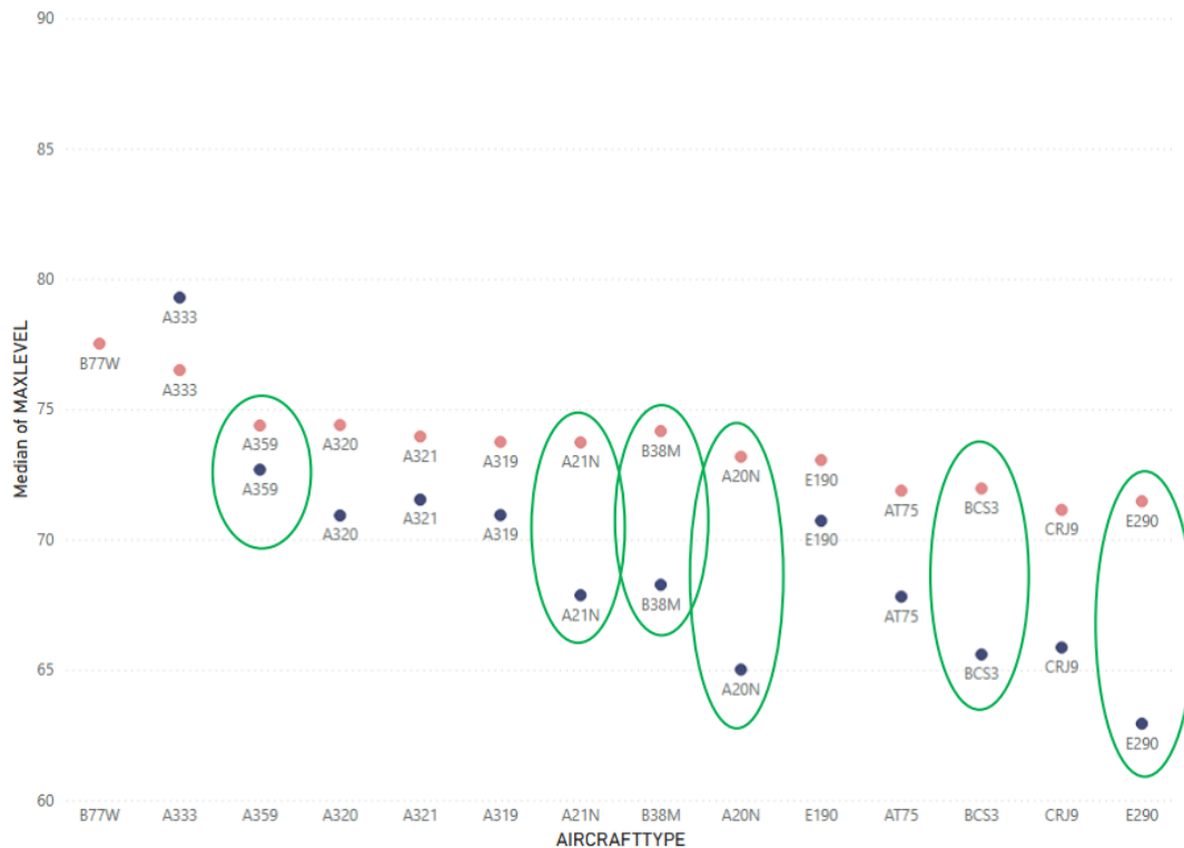
Kuva 4. Eri konetyyppien hetkelliset enimmäisäänitasot lentoalähdöissä ja laskeutumisissa Korson mittauspisteeltä mitattuna. Lähde: Finavia
