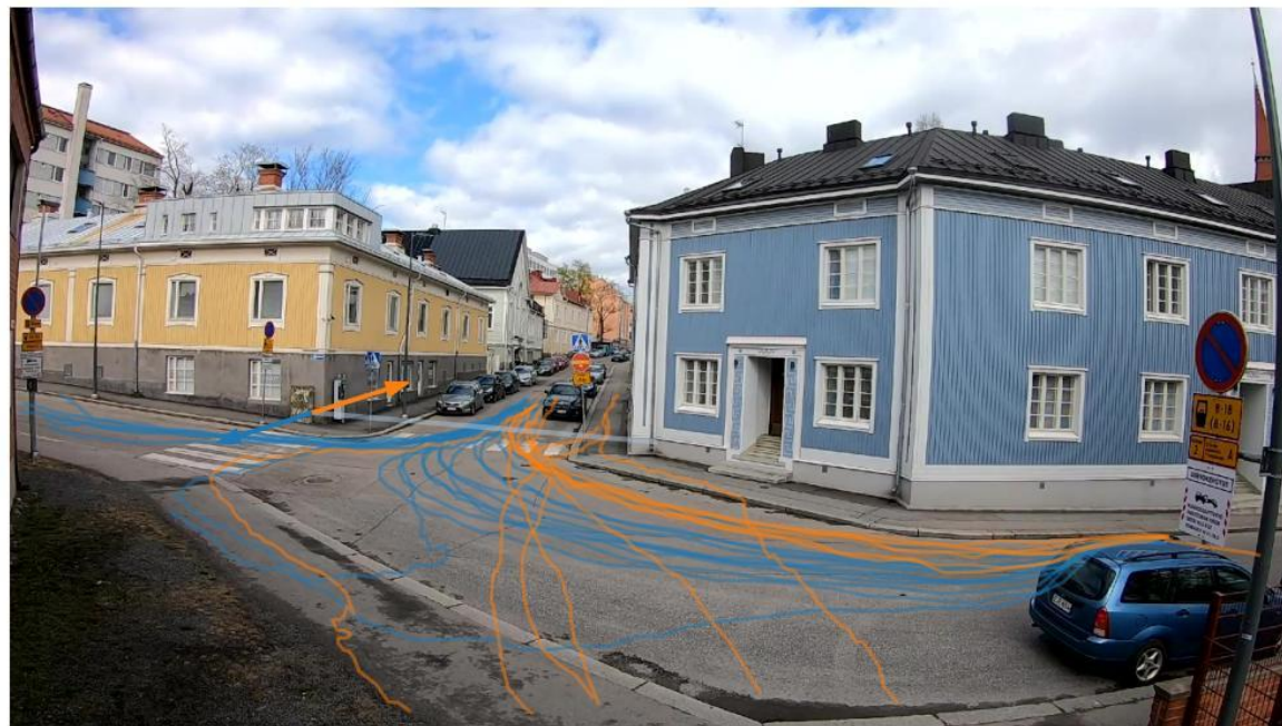
Kuva. Pyöräliikenteen ajolinjat poikkileikkauksessa (jälkeen, päivä 1).
