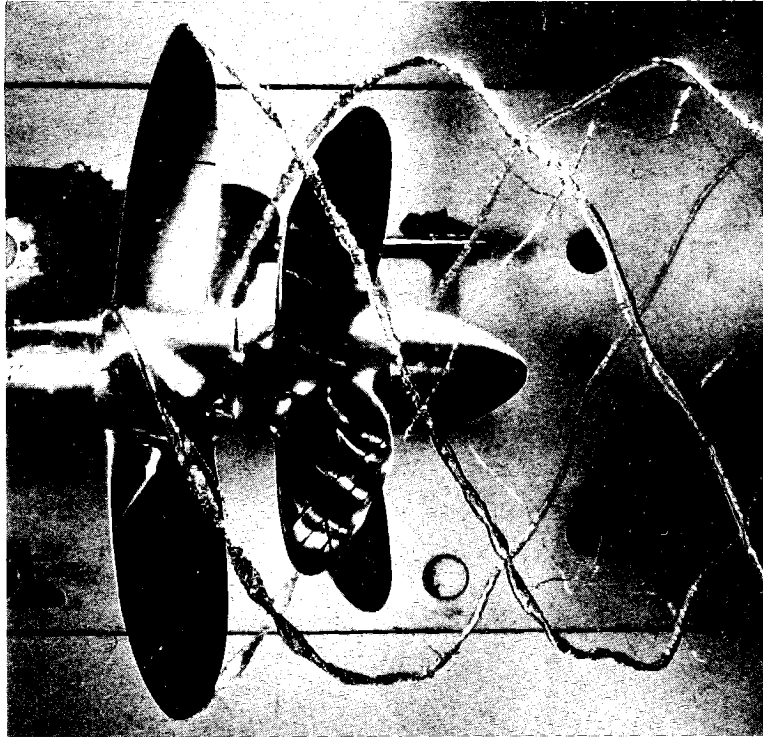
Fig. 3 Modellförsök. Motroterande propeller
