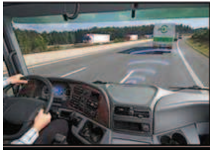
Kuva 3. Havaintokuva törmäyksen esto- ja varoitusjärjestelmästä.
