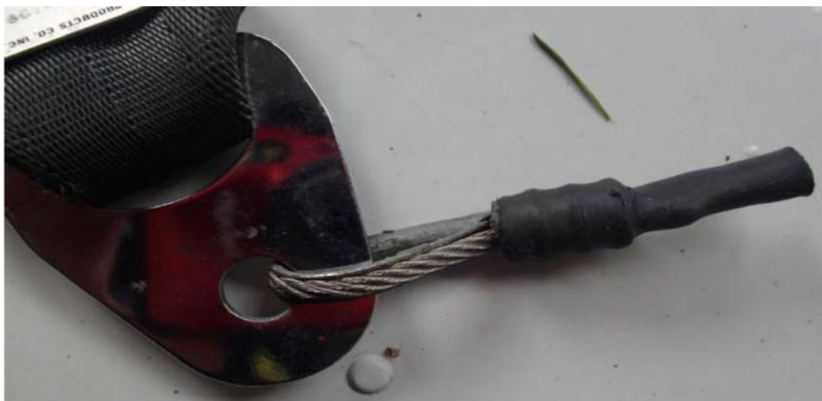
Kuva 1: Vaijeri on katkennut korroosion takia kutistesukan alta.
