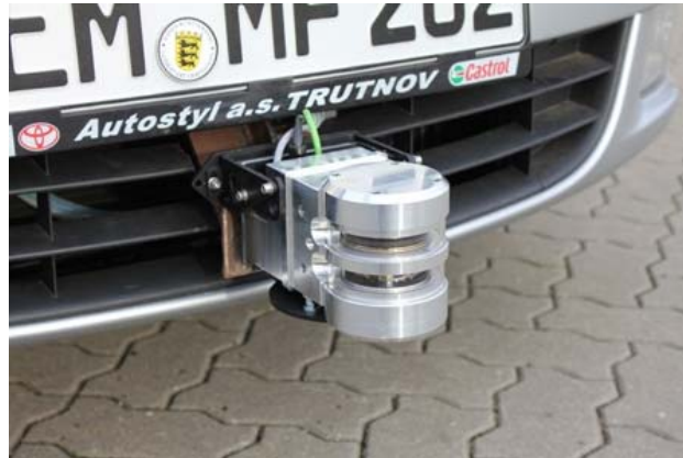
Kuva 10. Minifaros-lasertutkan prototyyppi (Minifaros, 2013)
