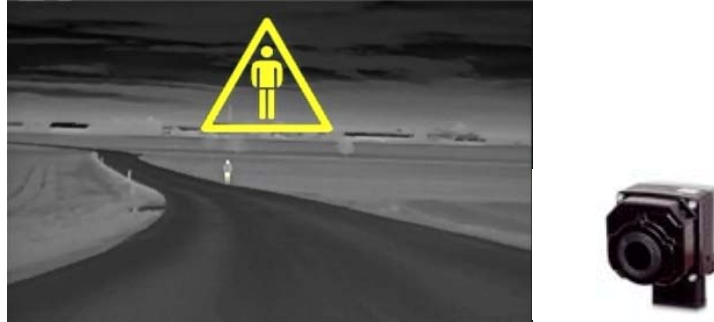
Kuva 9. Lämpökameran antama näkymä pimeässä. (Meiners, 2008) Oikealla ajoneuvokäyttöön tehty lämpökamera (Flir, 2014)
