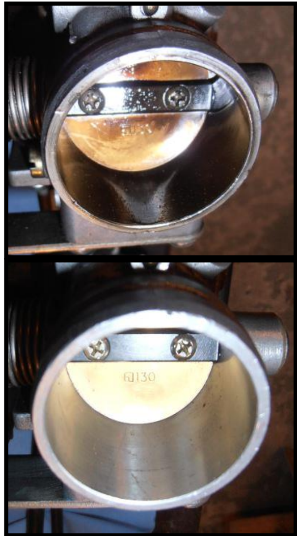
Kuva 4 Likainen ja puhdistettu kaasutin (huom. kuvassa ei ole "leko-kaasutin", mutta periaatteeltaan vastaava)
