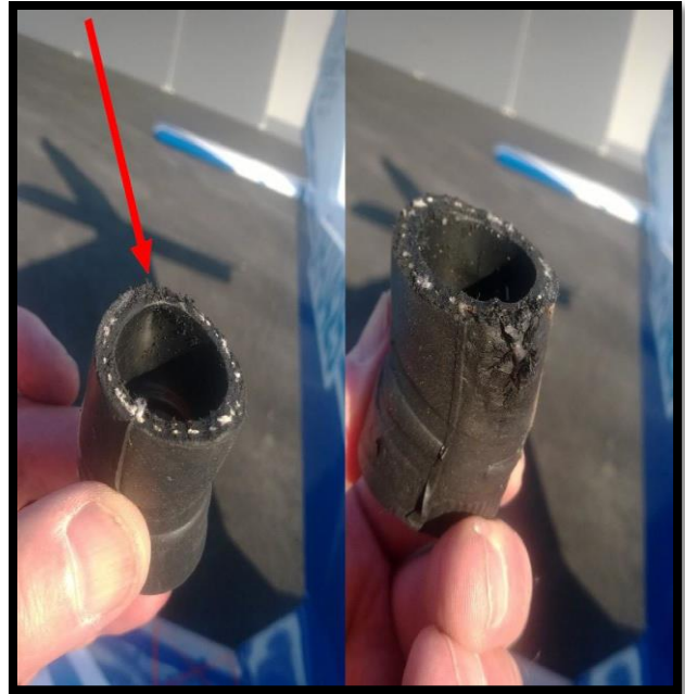
Kuva 2 Kuumuuden aiheuttama haurastuminen
