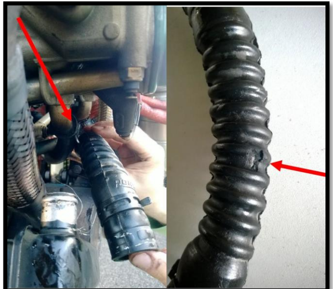
Kuva 3 Viereisen letkuliittimen vaurioittama letku
