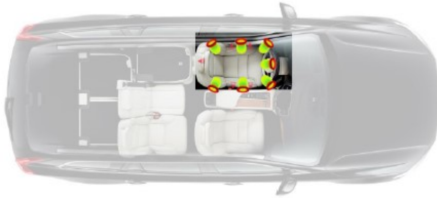
Kuva 5. Kuljettajan istuin geoidattuna matalan energia bluetooth BLE-anturein. (Raza 2017)
