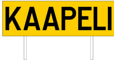
Kuva 5. Kaapeli- ja johtotaulu
