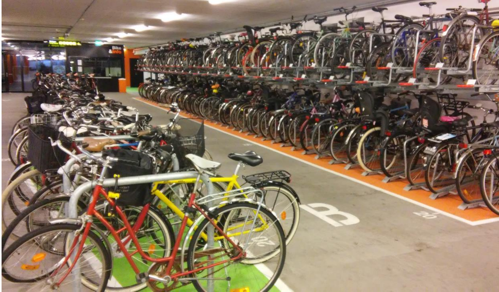
Kuva 22. Kaariteline soveltuu pyörille, joissa on etu- tai takakori tai muita lisävarusteita, mutta ovat helppokäyttöisyyteensä vuoksi suosittuja muutenkin.
