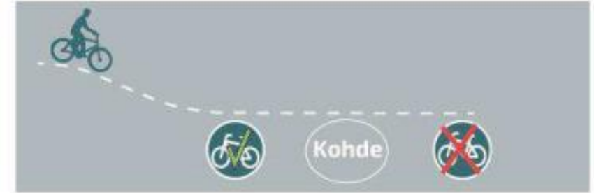
Pyöräpysäköinnin tulisi sijaita päälähestymissuunnassa mahdollisimman lähellä kohdetta ja kohdetta ennen. Kuva: Pyöräliikenteen suunnittelu, Väyläviraston ohjeita 18/2020
