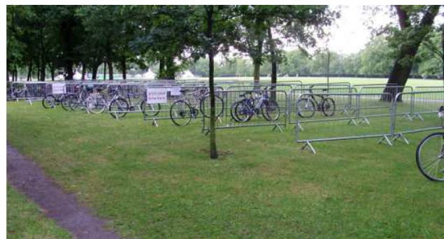
Kuva 8. Vasemmalla väliaikainen pyöräpysäköinti helposti liikuteltavilla runkolukitustelineillä ja oikealla kevyillä aidoilla järjestetty väliaikainen pyöräpysäköinti (Kuvan lähde: Transport for London ).
