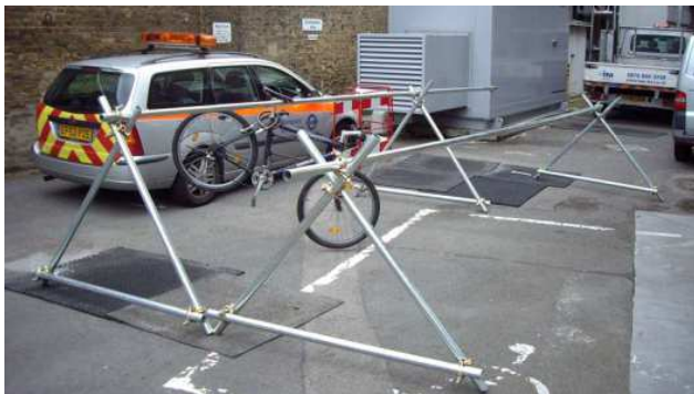
Kuva 9. Vasemmalla on esimerkki isommille tapahtumille telineputkirakennelmalla järjestetystä pyöräpysäköinnistä. Oikealla Cyclehoop-yrityksen tarjoama pysäköintipalvelu. (Kuvan lähde: Transport for London )
