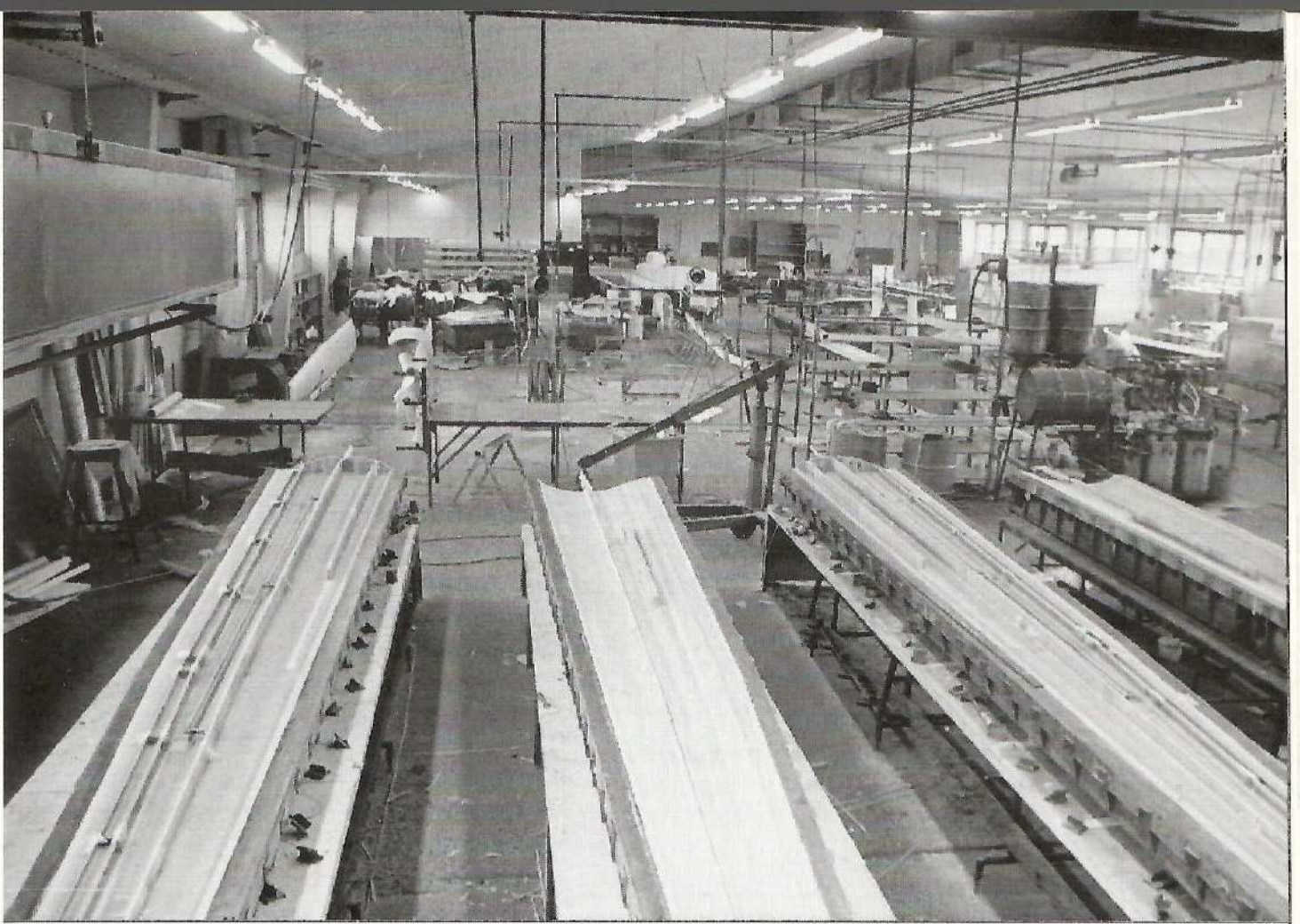
PIK-20 -sarjoja rakennettiin kaksilla siipi- ja runkomuoteilla. Kuva Markku Hiedanpää.
