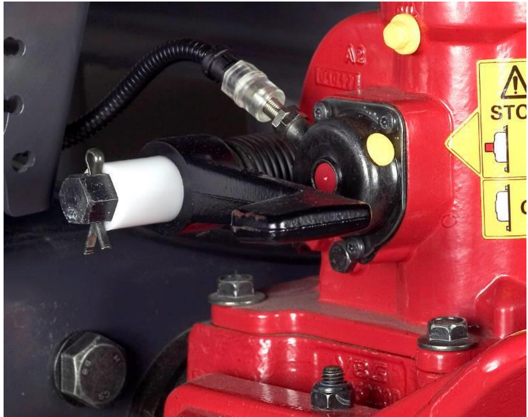
Kuva 8: Merkkivalon anturi vetokytkimessä, VBG
