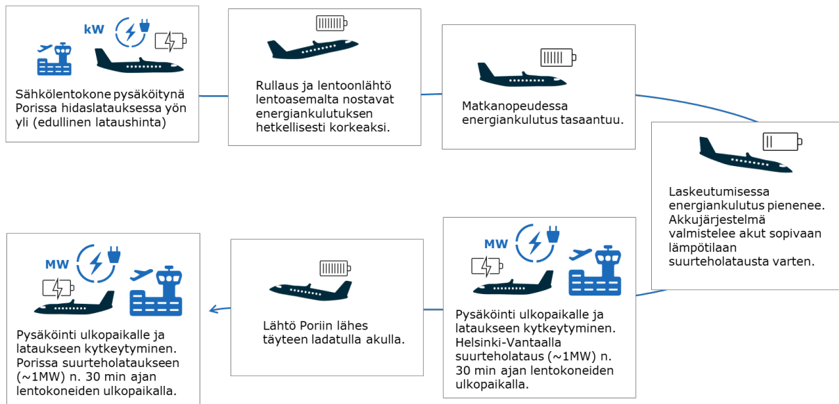
Kuva 14. Teoreettinen esimerkki yhdestä edestakaisesta matkasta akkusähkölentokoneella.
