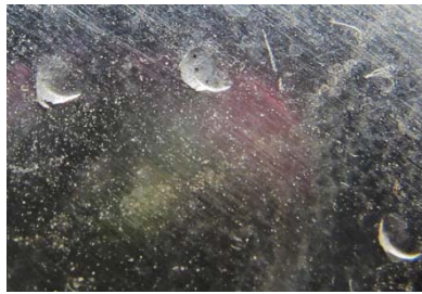
Nastan jälkiä alumiinilevyn pinnalla
