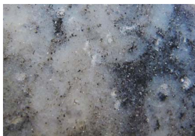
Nastan jälkiä kivilevyn pinnalla
