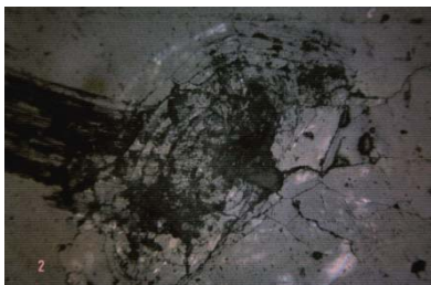
Nastaiskun aiheuttamia halkeamia kivilevyn pinnassa, raapaisujälki vasemmalle, ei irronnutta kiveä
