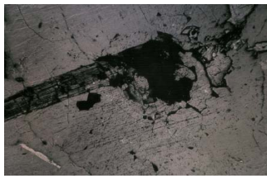
Nastaiskun aiheuttamia halkeamia kivilevyn pinnassa, raapaisujälki vasemmalle, vähän irronnutta kiveä
