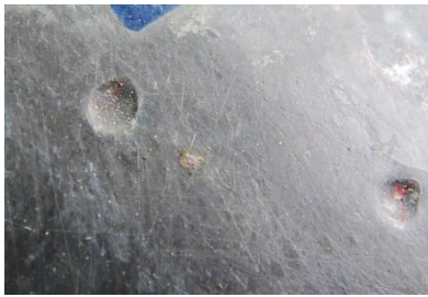
Nastan jälkiä lyijylevyn pinnalla
