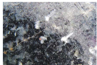
Nastan jälkiä kivilevyn pinnalla
