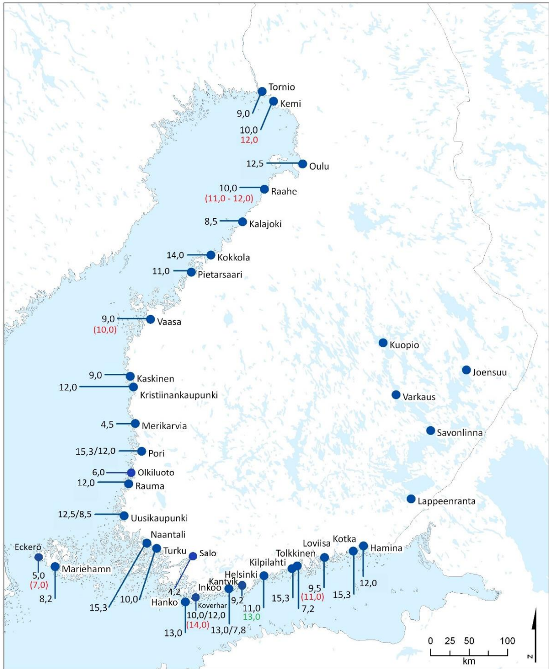
Kuva 6. Suomen merkittävimmät satamat sekä niihin johtavien syvimpien väylien kulkusyvytydet rannikon satamien osalta. Toteutus- tai suunnitteluvaiheessa olevien väylien kulkusyvytydet on merkitty seuraavasti: vihreällä toteutuksessa oleva hanke, punaisella suunnitteilla oleva, käynnistymistä odottava hanke ja suluissa punaisella suunnitteluhankkeet.
