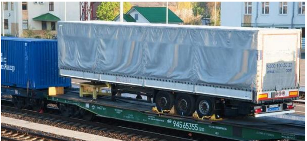
Kuva 12. Irtoperävaunun vetopisteen tuki kuljetuksen aikana. (kuva: Belarusian Railway).
