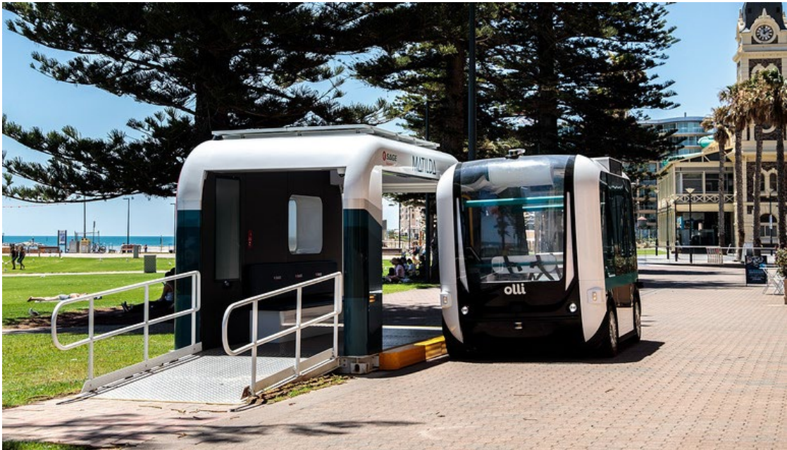
Kuva 4. Automaattibussi Olli ja sen kanssa yhteensopivaksi integroitu pysäkkikonsepti Matilda (kuvan lähde https://www.sageautomation.com/news/pages/matilda-smart-transit-hub-makes-australian-debut-at-worlds-first-integrated-driverless-technology-trial , 20.6.2019).
