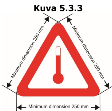
Kohotetussa lämpötilassa kuljetettavien aineiden varoitusmerkki Minimum dimension = Vähimmäismitta
