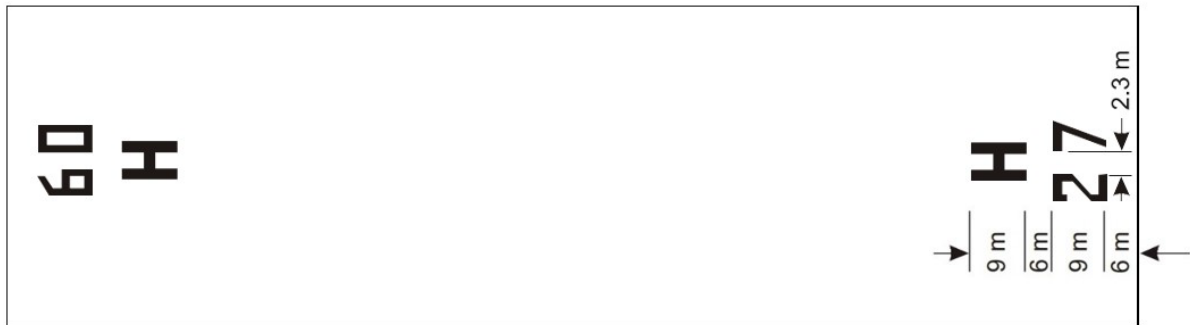
Kuva 5-3. FATO:n suuntamerkintä ja helikopterilentopaikan tunnusmerkintä (H) kiitotietyyppisellä FATO:lla.
